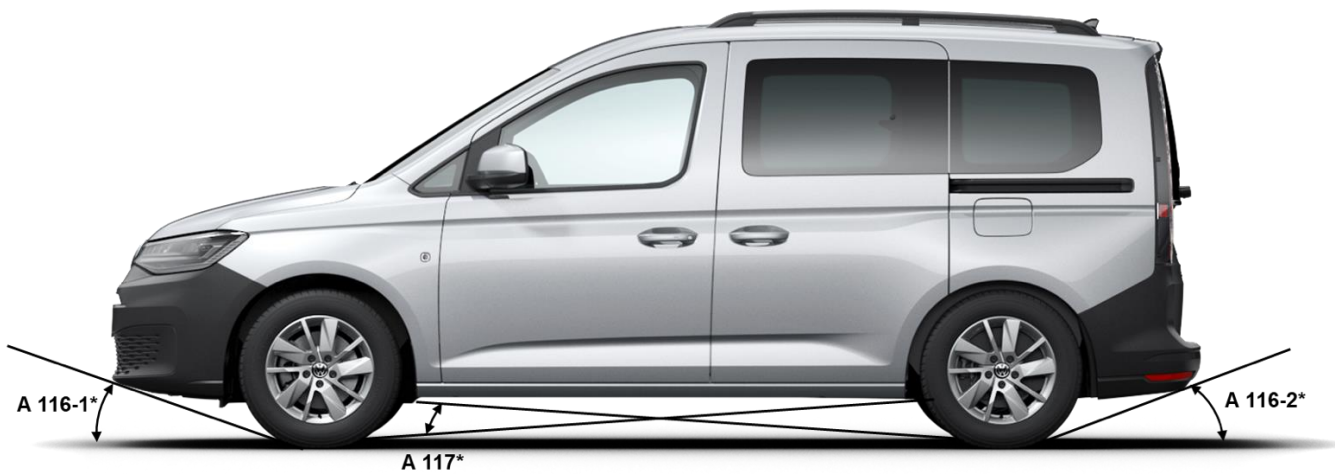
Abb. 2: Überhang- und Rampenwinkel Caddy
