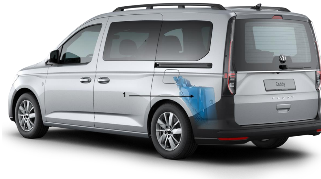
Abb. 1: Einbaulage des AdBlue-Tanks im Fahrzeug
