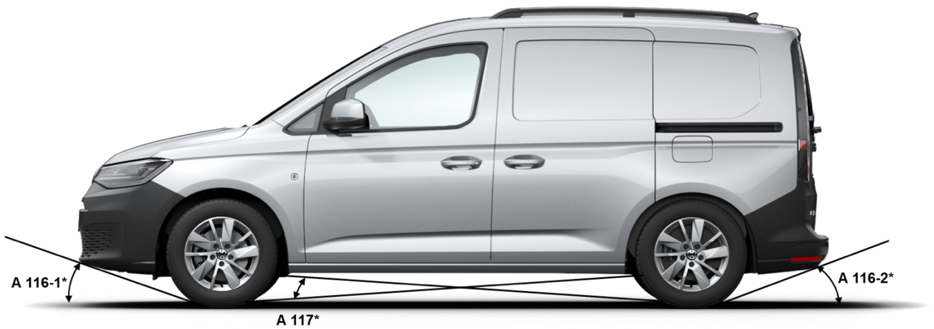
Abb. 1: Überhang- und Rampenwinkel Caddy Kasten
