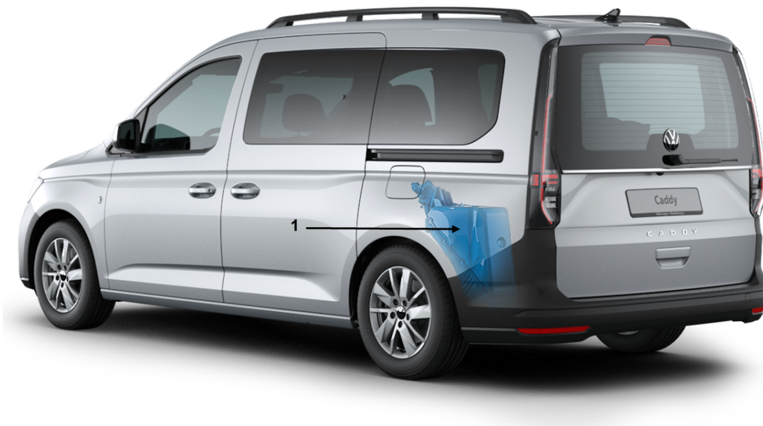
Abb.1: Einbaulage des AdBlue-Tanks im Fahrzeug
