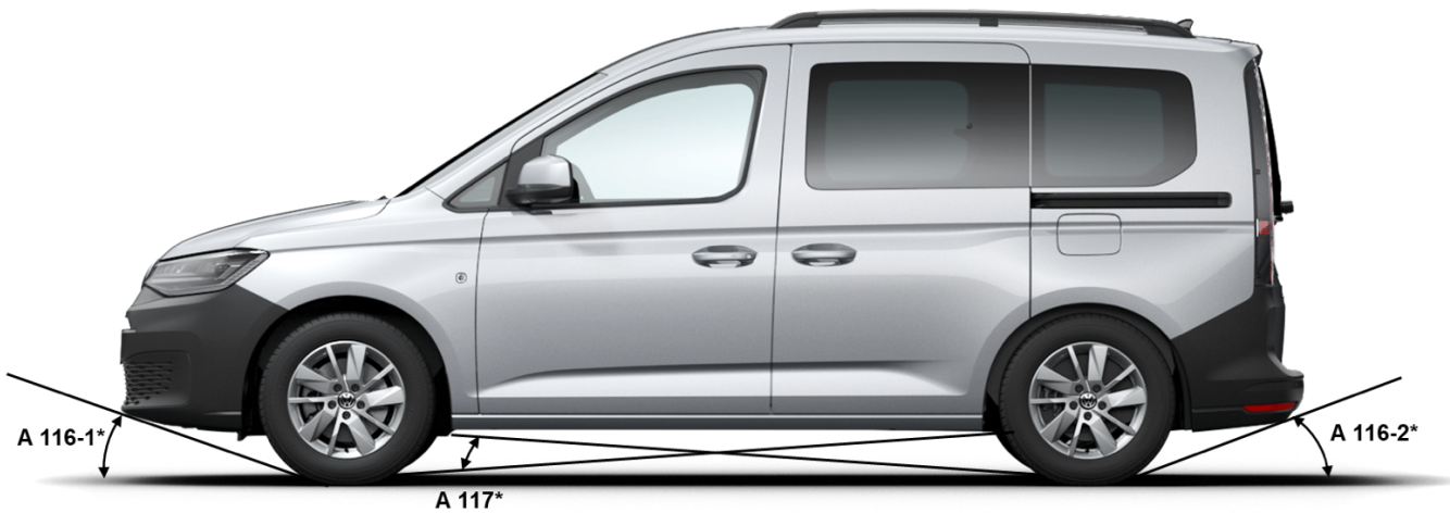
Abb. 2: Überhang- und Rampenwinkel Caddy Kombi
