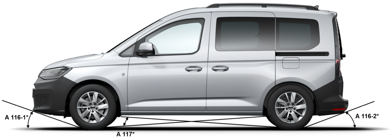
Fig. 2 : Angles d'attaque et de fuite, et angle de crête du Caddy
