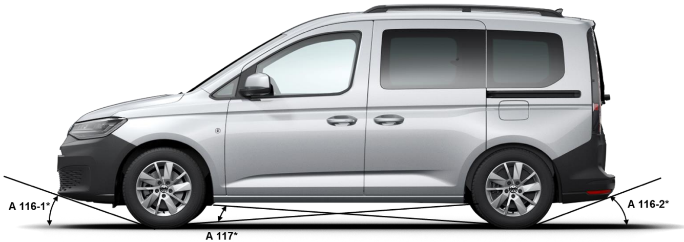
Fig. 2 : Angles d'attaque et de fuite, et angle de crête du Caddy fourgon vitré
