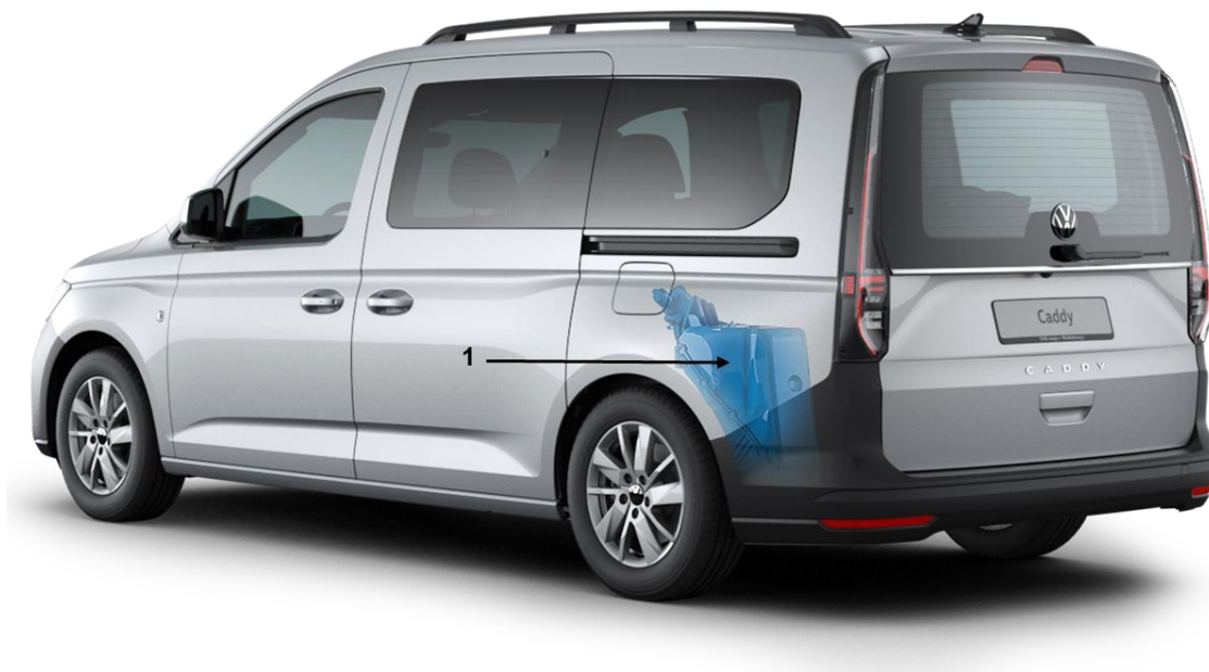
Fig. 1 : position de montage du réservoir d'AdBlue dans le véhicule
