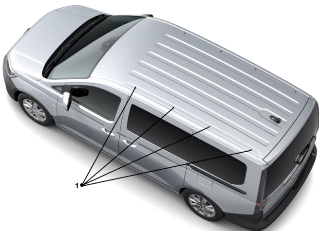
Fig. 2 : points de fixation - Caddy Maxi
