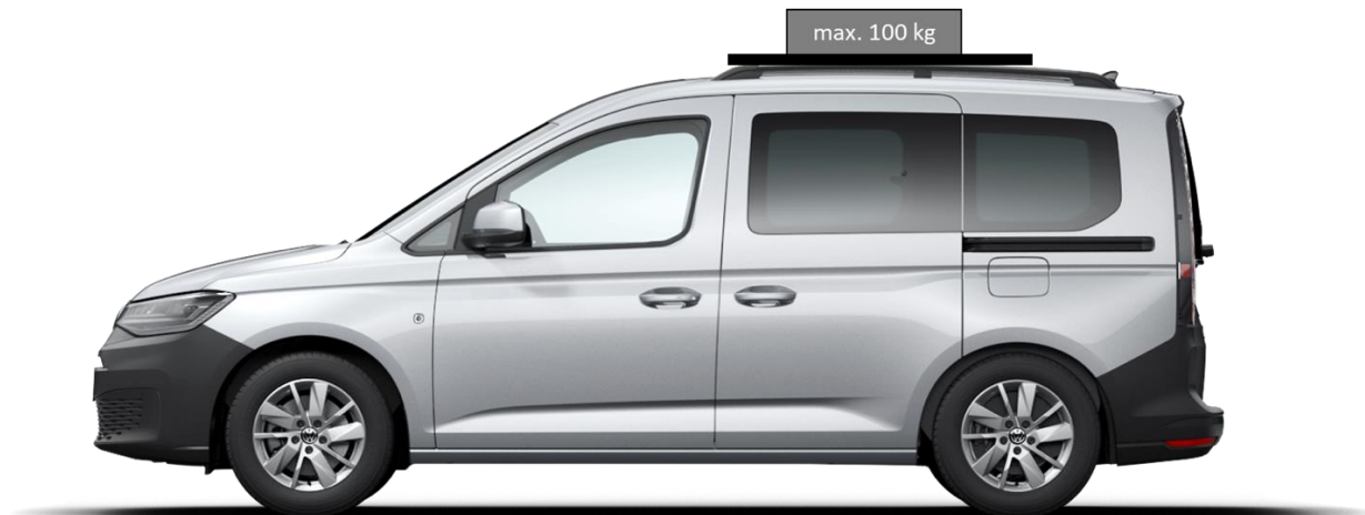
Fig. 1 : charge sur le pavillon
