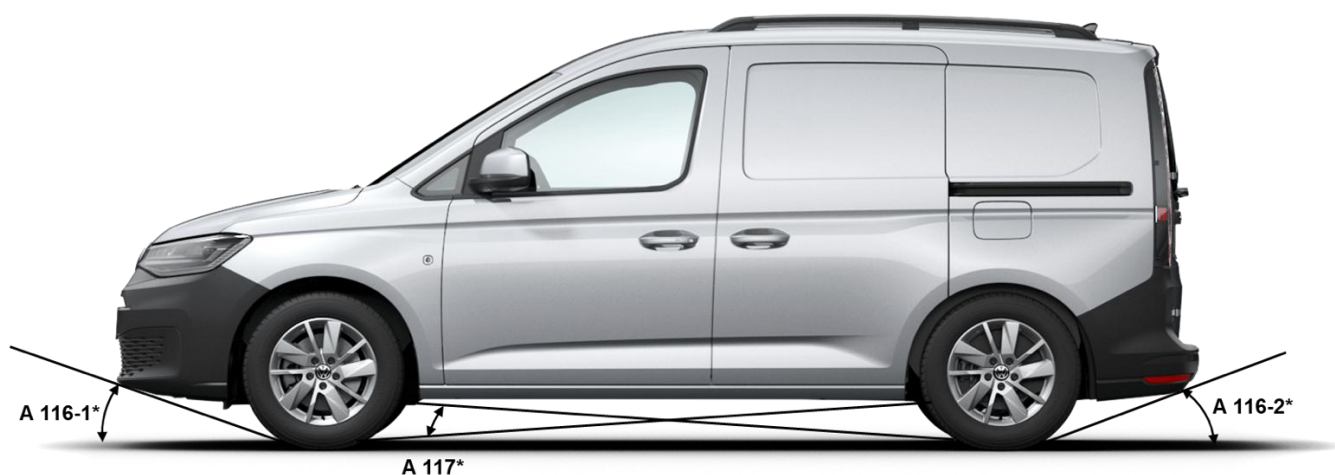
Fig. 1: angolo di attacco e angolo di rampa Caddy Cargo
