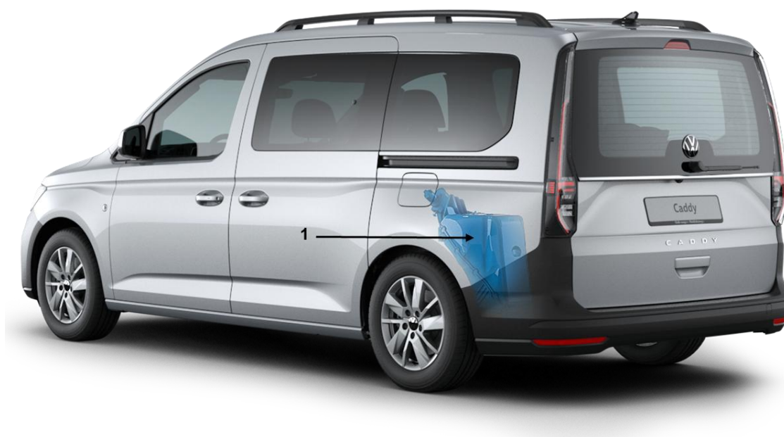
Fig. 1: posizione di montaggio del serbatoio dell'AdBlue sul veicolo
