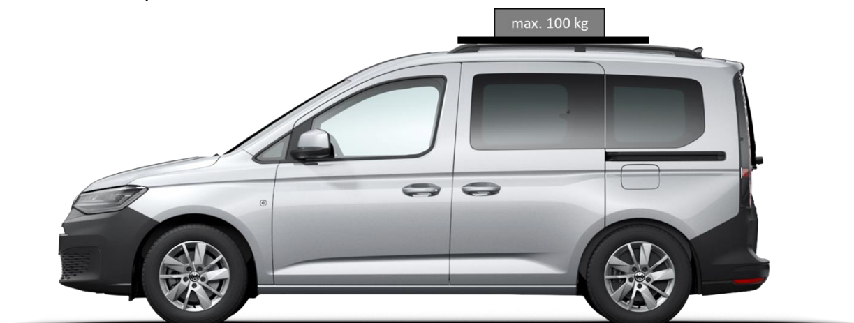
Fig. 1: carico sul tetto
