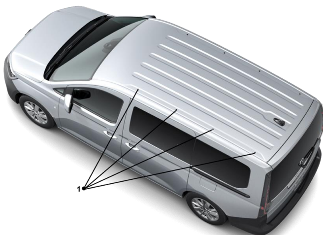
Fig. 2: punti di fissaggio Caddy Maxi
