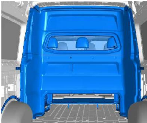
Abb. 2: Prinzipdarstellung für einen Ausbau Kastenwagen mit 3er Sitzbank / 4er Sitzbank in der 2. Sitzreihe. Ansicht von hinten.
