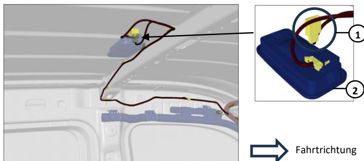
Abb. 4: Position Koppelstelle am Dach, für Rundumkennleuchte bei der Doppelkabine
