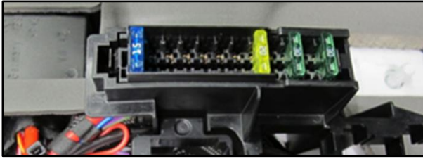
Abb. 3: Detail A: Sicherungshalter – Abnahmepunkt für Zweitatterie
