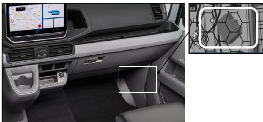
Barrette de raccordement (IS1) derrière le revêtement inférieur de montant A
