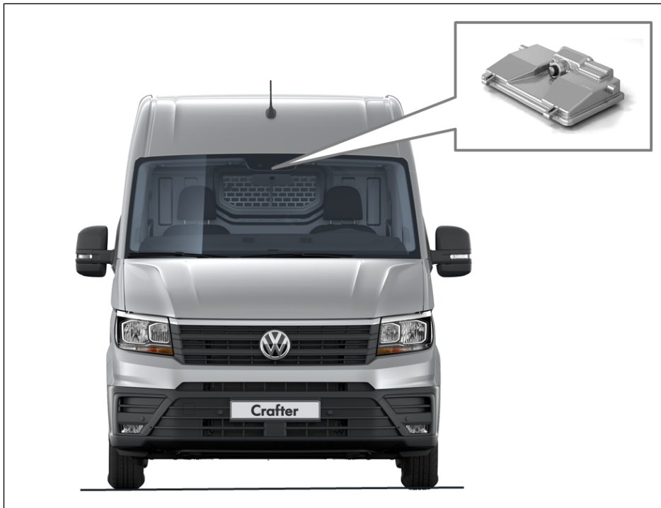
Fig. 1 : Position de la caméra frontale pour systèmes d'aide à la conduite dans le véhicule
