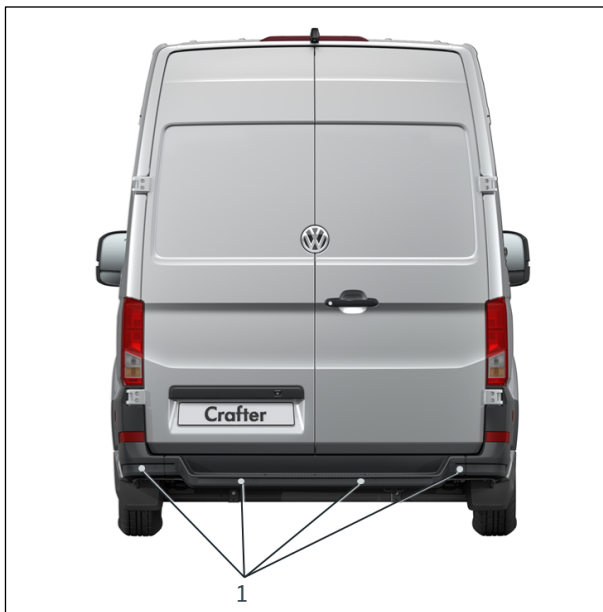
Fig. 2 : position des capteurs à ultrasons
