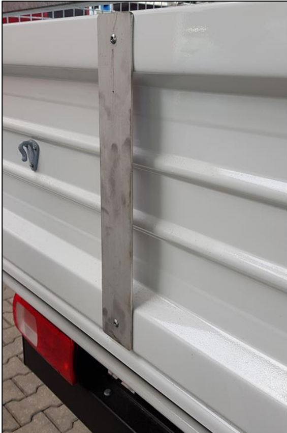
Fig. 3 : plaque de protection sur la paroi arrière du plateau
