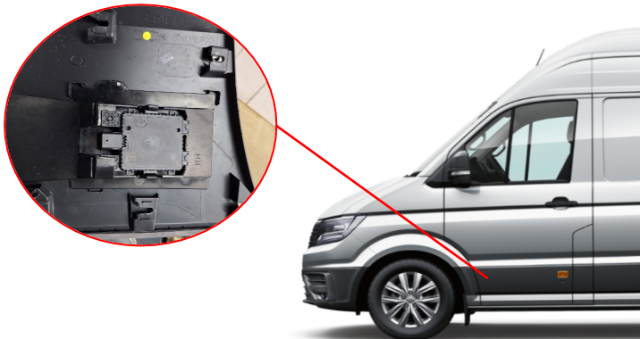
Fig. 3 : emplacement des capteurs radar dans la porte
