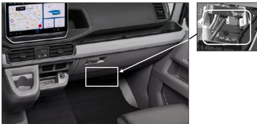
Position de montage du KFG sur le tableau de bord inférieur, derrière la boîte à gants.
