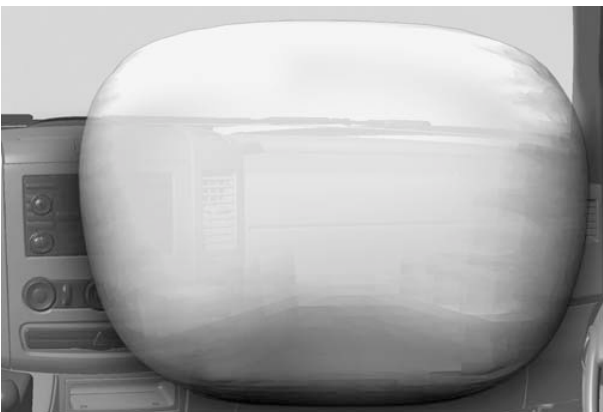
Zone de déploiement de l'airbag du passager avant (images en cours de traitement !)
