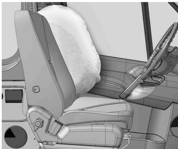
Zone de déploiement de l'airbag de thorax dans le véhicule à gauche (schéma de principe !)
