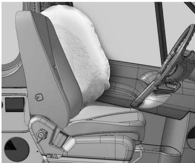
Zona di espansione thoraxbag, lato sinistro del veicolo (rappresentazione schematica!)
