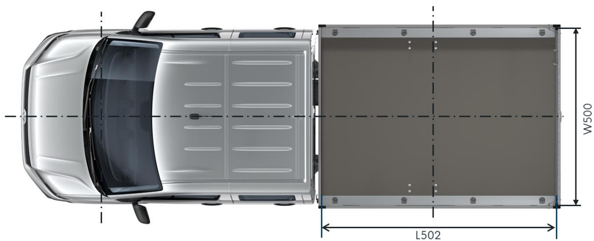
Fig. 2: dimensioni camioncino con cabina doppia / vista tetto
