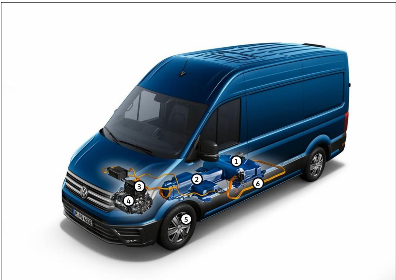
Fig. 1: sistema di trazione e-Crafter
