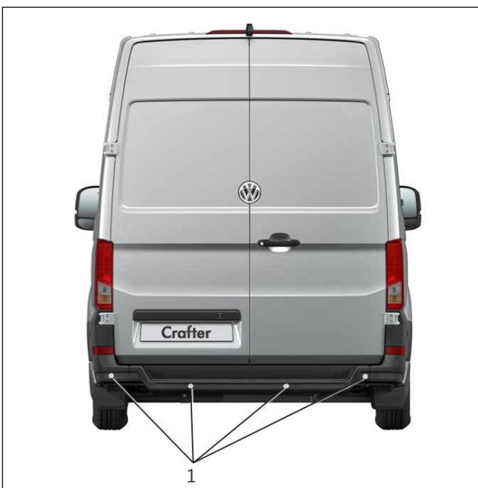
Figura 1: posizione dei sensori a ultrasuoni
