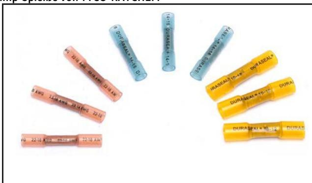
Die Volkswagen AG rät generell von der Verspleißung ab, da Verbindungen mit dieser Technik variierende und schwer einzuschätzende Merkmale aufweisen. Falls eine Verspleißung jedoch unumgänglich ist, muss sie mit dem aufschumpfbaren, versiegelten, nylonisierten Crimp-Spleiß DuraSeal (von TYCO-RAYCHEM) ausgeführt werden. Beispielsweise die Serie D406. Um die Integrität des Spleißes zu verbessern, muss der Spleiß mit einem Schrumpfschlauch versiegelt werden. Siehe Abbildung oben.
