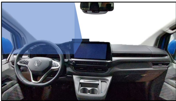
Fig. 1 : position et champ de vision de la caméra multifonction d'habitacle
