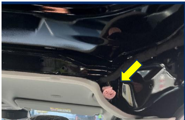
Fig. 1: rivestimento del tetto nella zona del montante B destro
