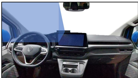
Fig. 1: posizione e visuale della telecamera multifunzionale interna
