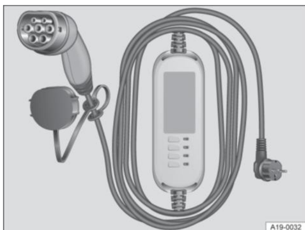
Fig. 4 : câble de recharge de secours pour prises secteur (schéma de principe)
