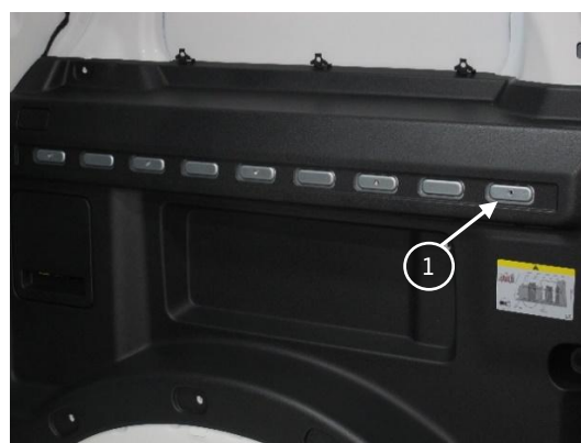
Fig. 4 : Surface de vissage sur le renfort
