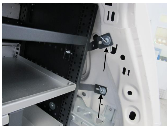
Fig. 5 : schéma de principe, vue d'un assemblage vissé sur la tôle intérieure avec plaque d'insertion stable
