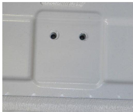
Fig. 4 : Points de vissage dans le plancher du véhicule
