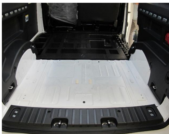
Fig. 3 : vue des points d'arrimage et des points de vissage
