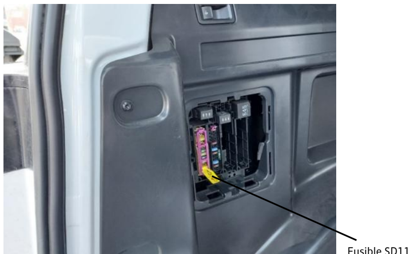
Fig. 1 : position du porte-fusibles D dans l'espace de chargement à gauche derrière le revêtement
