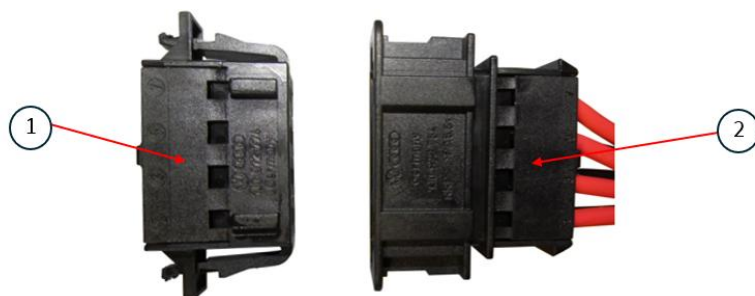
Fig. 2 : connecteur et connecteur homologue
