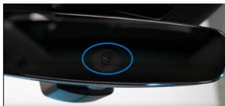
Fig. 1-Caméra multifonction d'habitacle (MIK)
