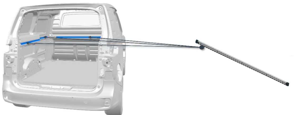
Fig. 1 : rails ZSB cloison (rails d'arrimage sur la cloison et les pièces latérales)
