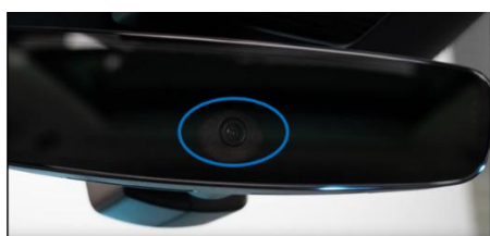
Fig. 1: telecamera multifunzionale interna (MIK)
