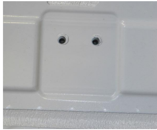
Fig. 4: punti di avvvitamento nel pavimento del veicolo
