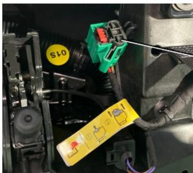
Fig. 2: connettore di manutenzione sul supporto serratura anteriore destro
