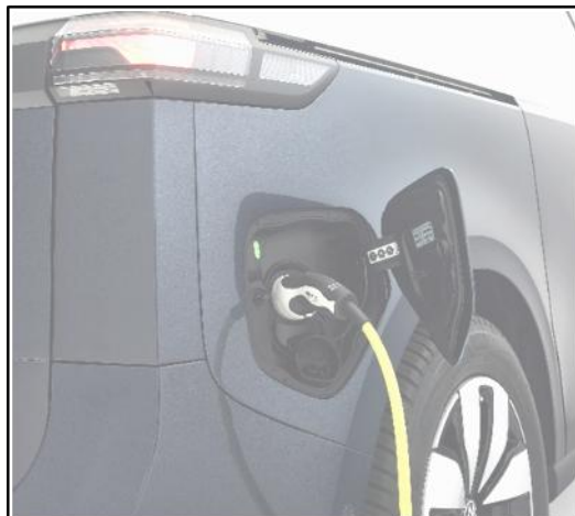
Fig. 1: posizione della presa di ricarica nella zona posteriore destra
