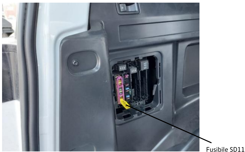
Fig. 1: posizione del portafusibili nella zona sinistra del vano di carico, dietro il rivestimento
