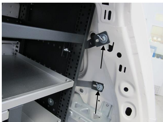
Fig. 5: vista di un collegamento a vite sulla lamiera interna con piastra d'inserimento stabile
