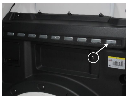
fig. 4: superficie di avvitamento sul rinforzo
