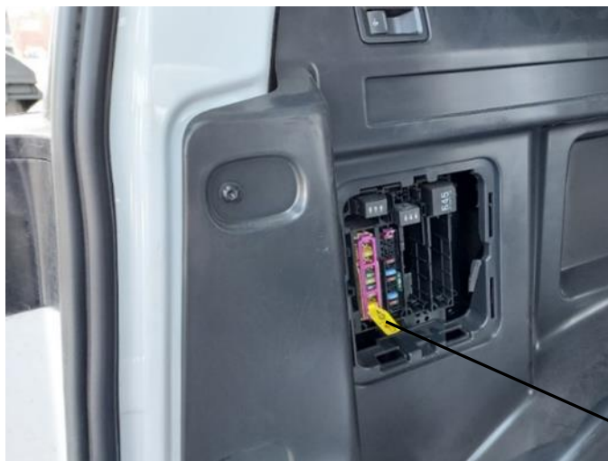
Fig. 1: posizione del portafusibili nella zona sinistra del vano di carico, dietro il rivestimento
