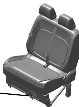
Fig. 2: posizione della presa di corrente interna a 230 V (sedile del passeggero anteriore doppio)
