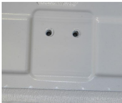
Fig. 4: punti di avvvitamento nel pavimento del veicolo
