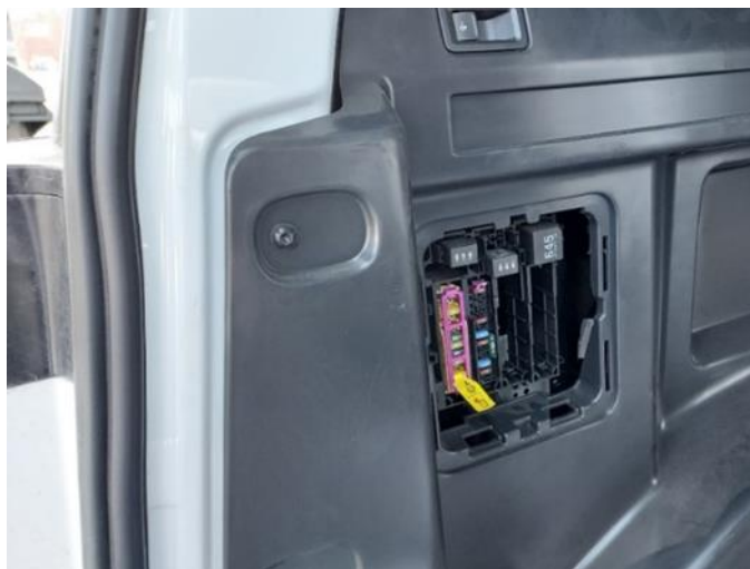
Fig. 1: posizione del portafusibili nella zona sinistra del vano di carico, dietro il rivestimento
