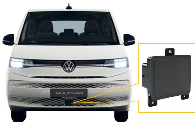
Fig. 6 : capteur radar avant avec calculateur de régulateur de distance (monté derrière le cache inférieur dans le pare-chocs)
